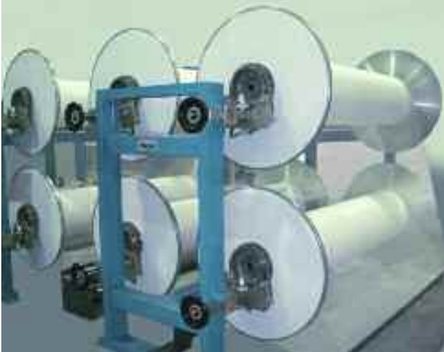
Beam creel RN Baumablaufgestell RN
