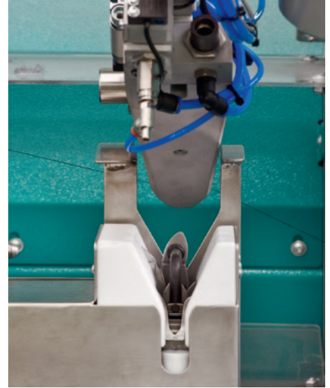
Knotting of yarn ends Anknoten der Fäden
